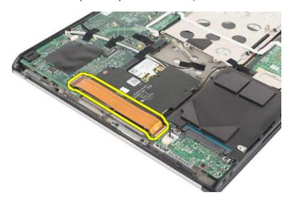
Disposez le câble souple de disque dur afin de laisser la place pour le butoir en caoutchouc.
