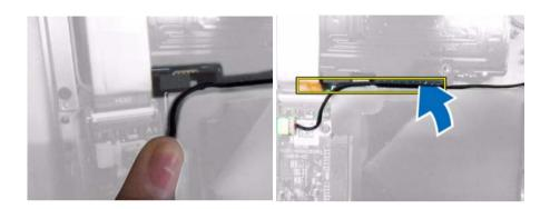
Fixez l'adhésif double-face au-dessus du câble et du butoir en caoutchouc pour garantir que le câble est sécurisé.
